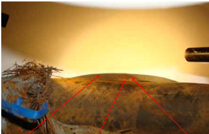
Flanke des Riss-Längsspalt Lunker im Kraterkern Kernbereich der Riss-Initialzone (Riss-Krater)
