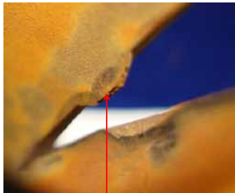
Die Pinzettenspitze weist auf die Lunkerstelle im Kernpunkt des initialen Rissbereiches
