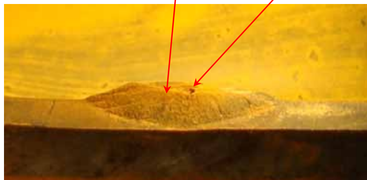
Nicht homogen verschmolzener Kautschuk – Agglomerat (Sinterzustand)
