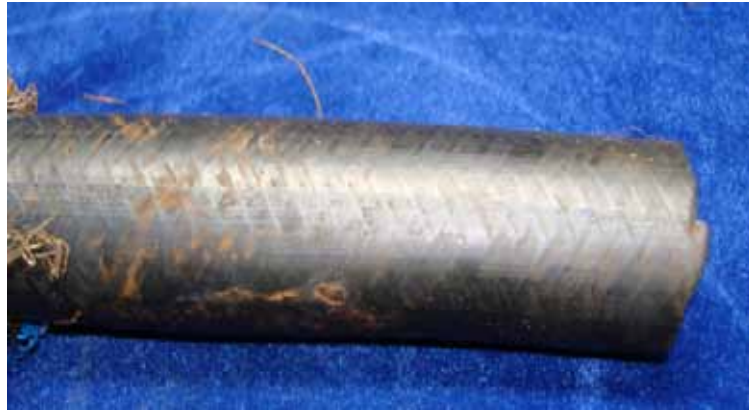
Oberfläche des Schadensschlauches im direkt an den Riss angrenzenden Bereich
