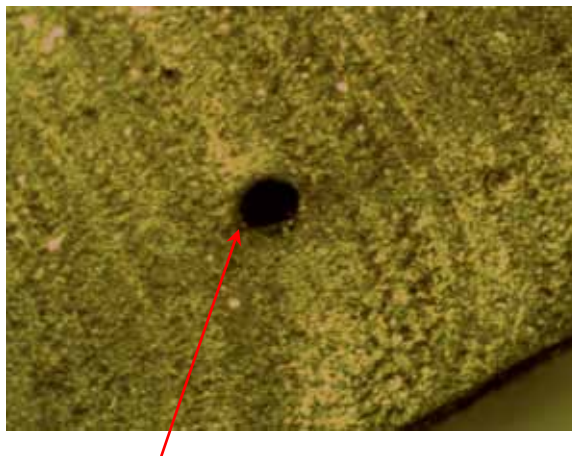
Weitere Fehlerfundstelle im Querschnitt (Loch)
