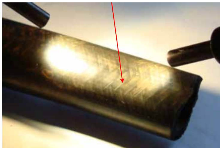
Riefen des äußeren Stützgewebes – keine Fließnähte erkennbar
