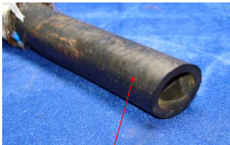
Riefen des äußeren Stützgewebes – keine Fließnähte erkennbar
