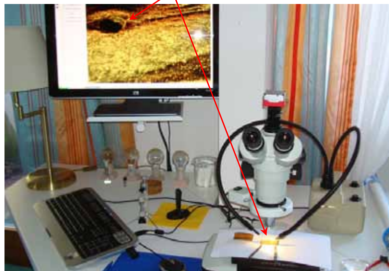
Original Initialschadens-Lunker Gleiche Stelle unter dem Mikroskop mit seitlichem Fortschritttriss
