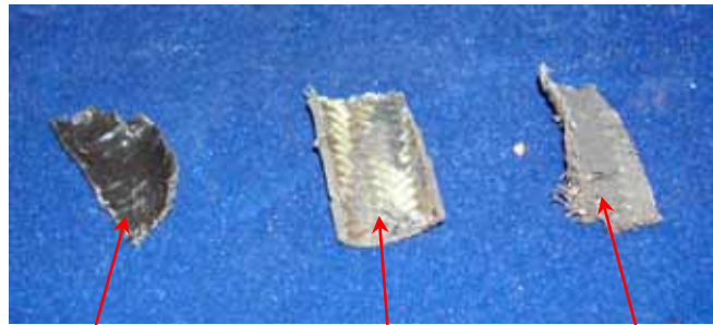
Innenschlauch PA11 – Gummi-Außenmantel - Metall-Gewebe-Schicht
