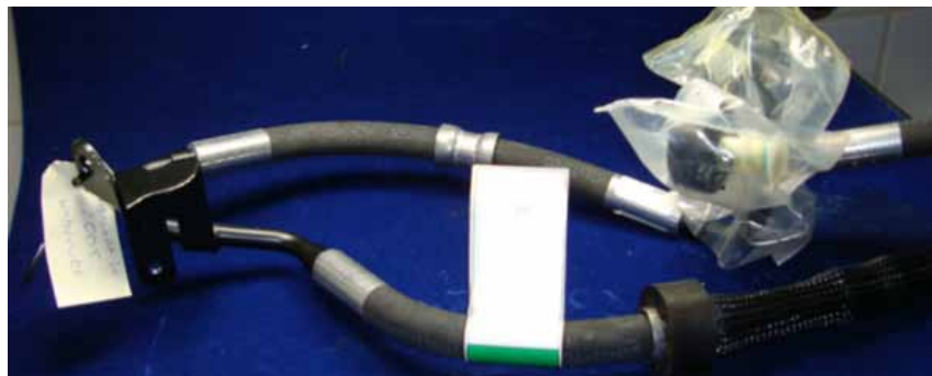
Referenz – Muster – Schlauch - 0 km – Hergestellt 2005 Neuteil – vor Einbau am Band genommen
